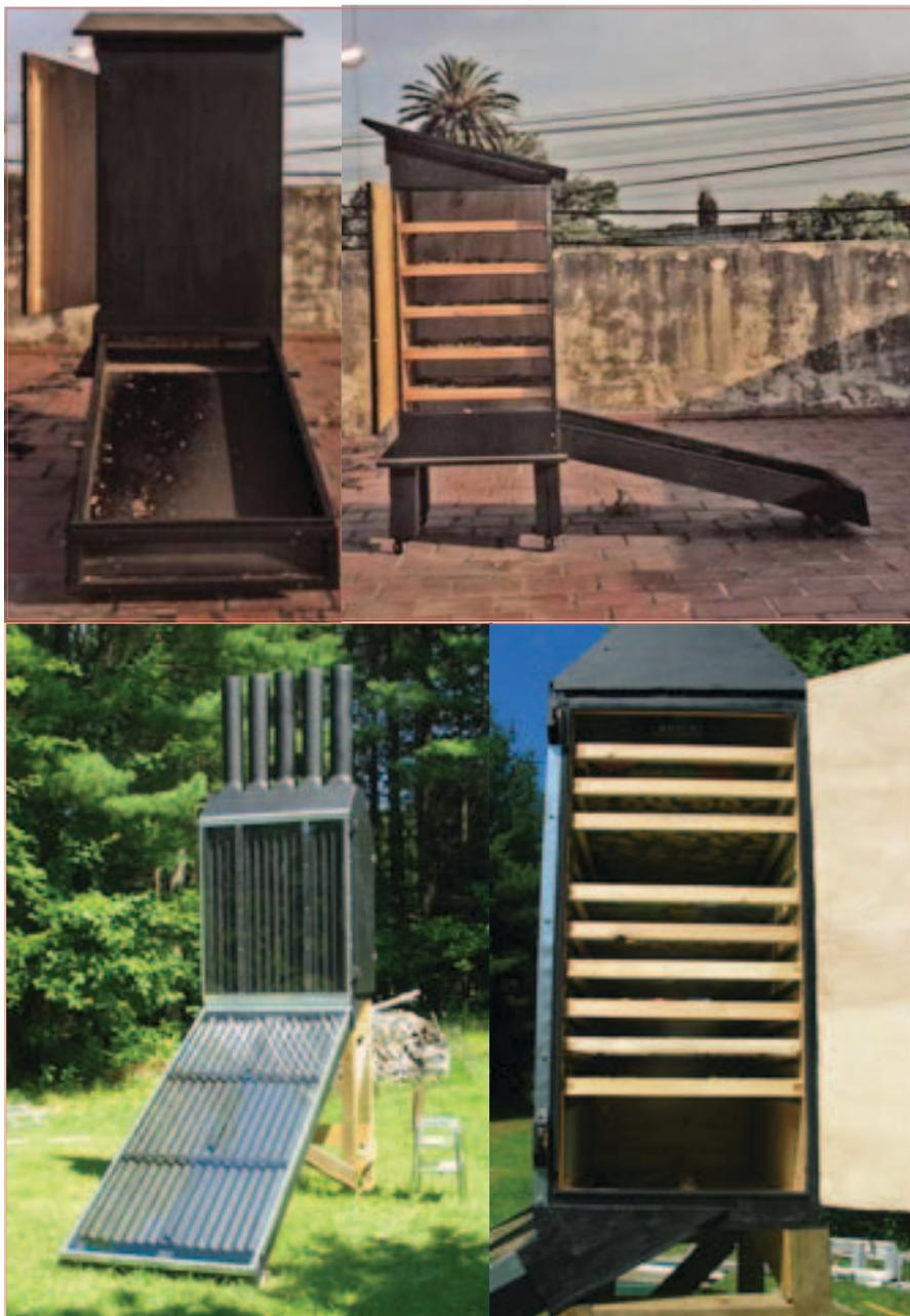
Figura 8: Secaderos solares sin y con chimeneas para regular la velocidad del aire (imágenes tomadas de internet)
